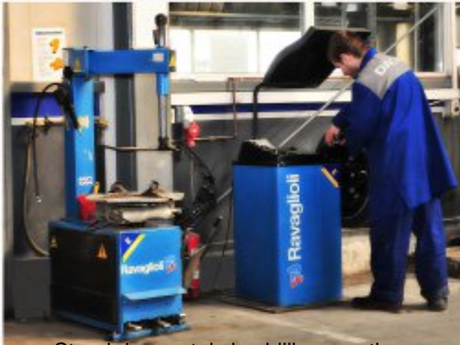
Standa de montaj și echilibrare roți cu linii arătătoare ATELIERUL DE ÎNLOCUIRI ȘI VOPȘĂRI
